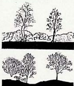
(Abb. 5: Wallhecke in gutem Zustand. Kraut-, Strauch- und Baumschicht vorhanden. Zaun in einem Abstand von 0,50 - 1,00 m zum Wallheckenfuß vorhanden.)
